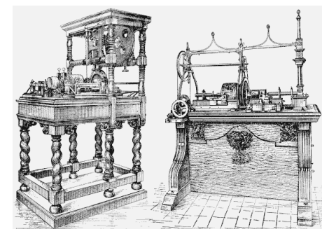
Рис. 1. Токарно-копировальный станок А.К. Нартова 1712 г. в стиле русского барокко (слева). Большой токарно-копировальный станок А.К. Нартова 1718–1729 гг. в стиле петровского барокко (справа) [Кочегаров, 2006, 42]
